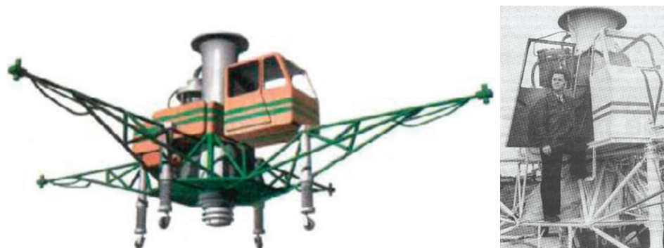
Рис. 12. Динамический стенд-тренажер разработки ЛИИ МАП СССР на базе турболета (слева), ведущий летчик-испытатель Ю.А. Гарнаев (справа)
