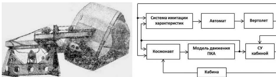
Рис. 16. Кабина в кардановом подвесе для «ВИ-4ЛК» и блок-схема системы управления
