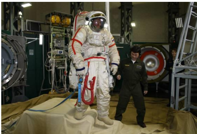
Рис. 3. Перемещение космонавта по «лунной» поверхности в условиях пониженной весомости на тренажере «Выход-2»
