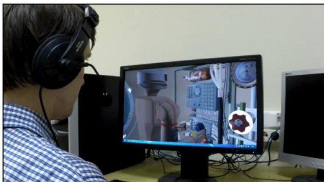
Рис.4. Реализация супервизорного режима управления манипуляционным роботом с использованием голосовой команды (дизайн модели и лабораторного эксперимента НИИСИ РАН). Комментарий. Задача для робота: распознав команду голосом от оператора «Робот, включи свет», робот должен нажимать на кнопку пульта для включения света
