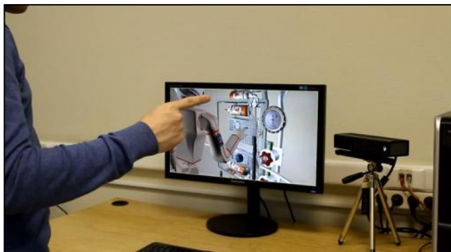
Рис. 3. Реализация копирующего режима управления с помощью изделия «Кинект» (дизайн модели и лабораторного эксперимента НИИСИ РАН). Комментарий. Задача для робота: повторяя движение руки ЧО, робот должен нажимать на кнопку пульта для включения света
