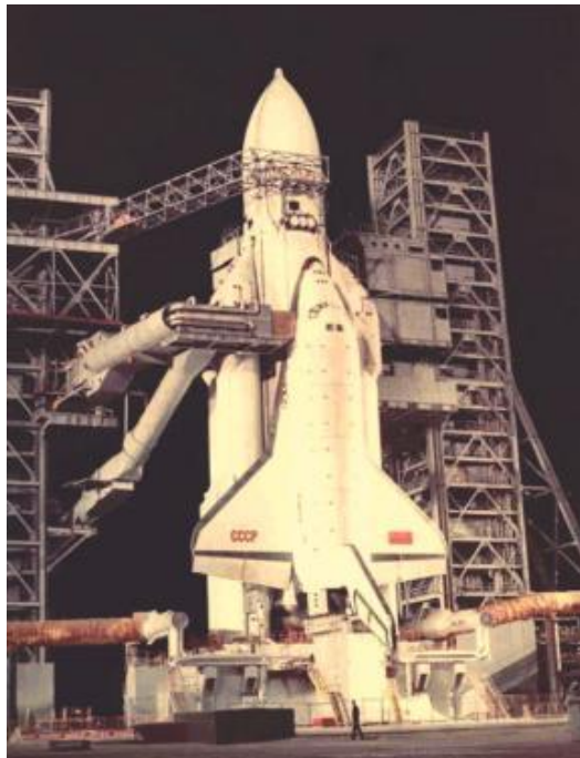
Рис. 2. Агрегат экстренной эвакуации экипажа и обслуживающего персонала корабля «Буран» (вид со стороны верхней части корабля)
