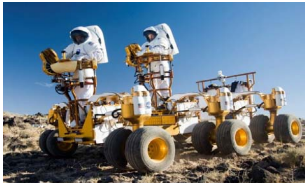
Рис. 4. Негерметичное транспортное средство для передвижения по планетам
