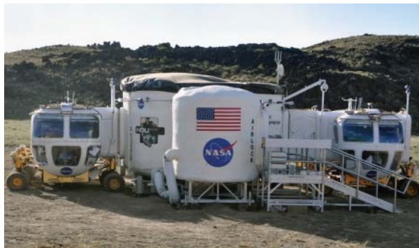
Рис. 3. Два марсохода подключены к демонстрационной обитаемой установке в ходе полевых испытаний в штате Аризона
