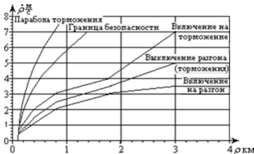
Рис. 4. Зависимость радиальной скорости \dot{\rho} от дальности \rho (фазовый портрет режима сближения «Союза» с МКС)
