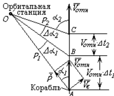
Рис. 2. К определению углового промаха \alpha по измерениям двух интервалов времени
