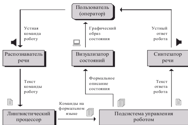
Рис. 3. Функциональная схема типичного построения системы речевого управления роботом (воспроизводится из работы [5])
