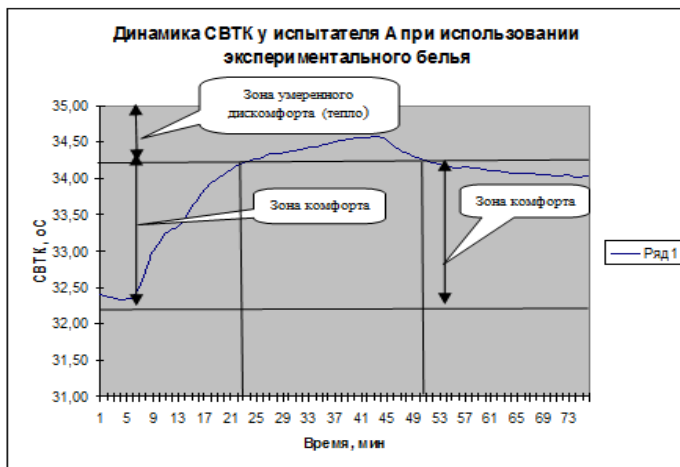
Рис. 7. График изменения средневзвешенной температуры кожи испы­тателя при использовании штатного и экспериментального спецбелья
