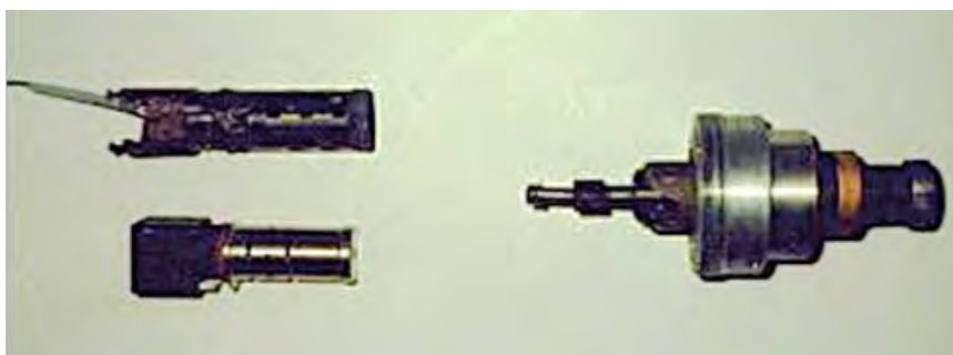
а) полый катод (КБ «Факел»); б) подогревной гексаборидный катод (справа)
